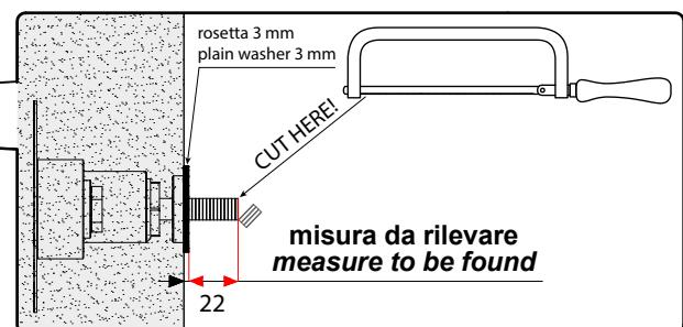
**7****Fissaggio perno e supporto rosetta**
