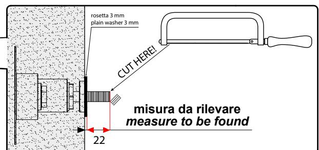
**6****Montaggio elementi di fissaggio**
